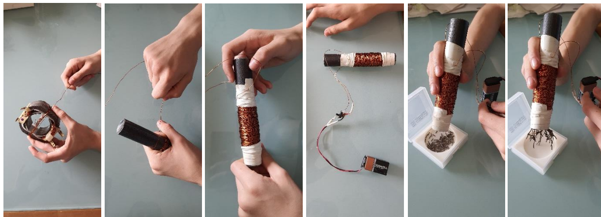
Il mio esperimento: costruzione e test di un'elettrocalamita
